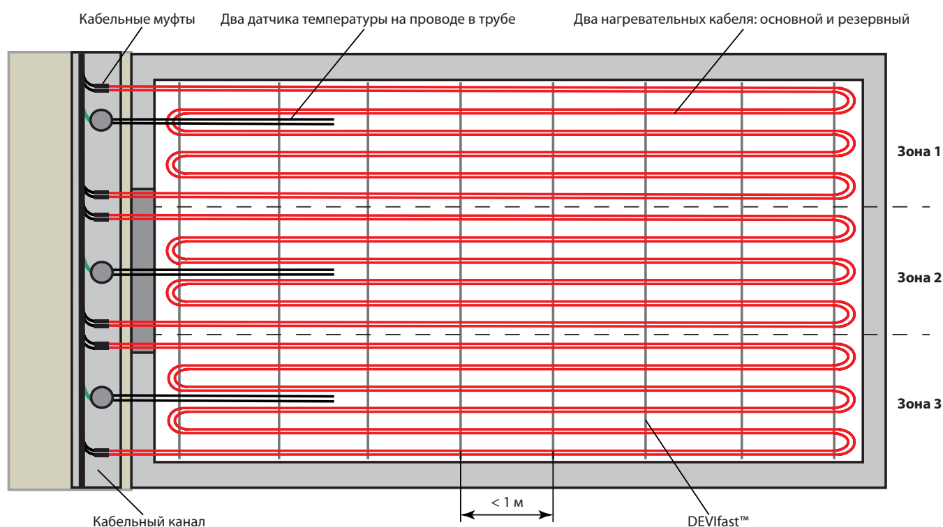
Рис. 6 – Система обогрева с 3 зонами. Пары нагревательных кабелей и датчиков (основные и резервные)
