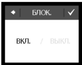
Теперь при нажатии на дисплей на нем появится символ блокировки доступа.
