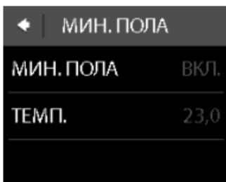
4. Нажмите **ТЕМПЕРАТУРА**. Затем используйте стрелки < и > для установки минимальной температуры пола. Нажмите  для подтверждения.
