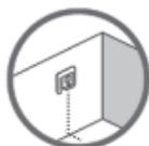
**Замечания по использованию терморегулятора.** Датчик температуры пола рекомендуется использовать во всех системах подогрева пола. Он **обязателен к применению** с тонкими матами и деревянными покрытиями пола для снижения вероятности их перегрева.
