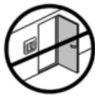
Во избежание влияния сквозняков терморегулятор должен располагаться на расстоянии не менее 50 см от окон и дверей, если регулировка осуществляется: в режиме совместного использования датчика температуры пола и датчика температуры воздуха или в режиме использования только датчика температуры воздуха.
