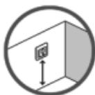
Разместите терморегулятор на стене на удобной высоте (обычно 80–170 см). Переключатель можно разместить в свободной области на стене.
