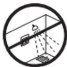
Не следует устанавливать терморегулятор/переключатель в помещениях с повышенной влажностью. Терморегулятор/переключатель должен размещаться за пределами зоны 2. Разместите его в соседнем помещении и используйте режим «только датчик температуры пола». При монтаже терморегулятора/переключателя соблюдайте местные нормы относительно класса защиты «IP».
