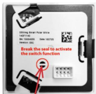
Кроме того, доступен режим «только датчик температуры воздуха», но для его активации необходимо сломать (например, с помощью отвертки) небольшую пластиковую перемычку и уплотнение в нижней части печатной платы на задней стороне модуля дисплея. Далее следует выполнить сброс. После этого можно устанавливать максималь-
